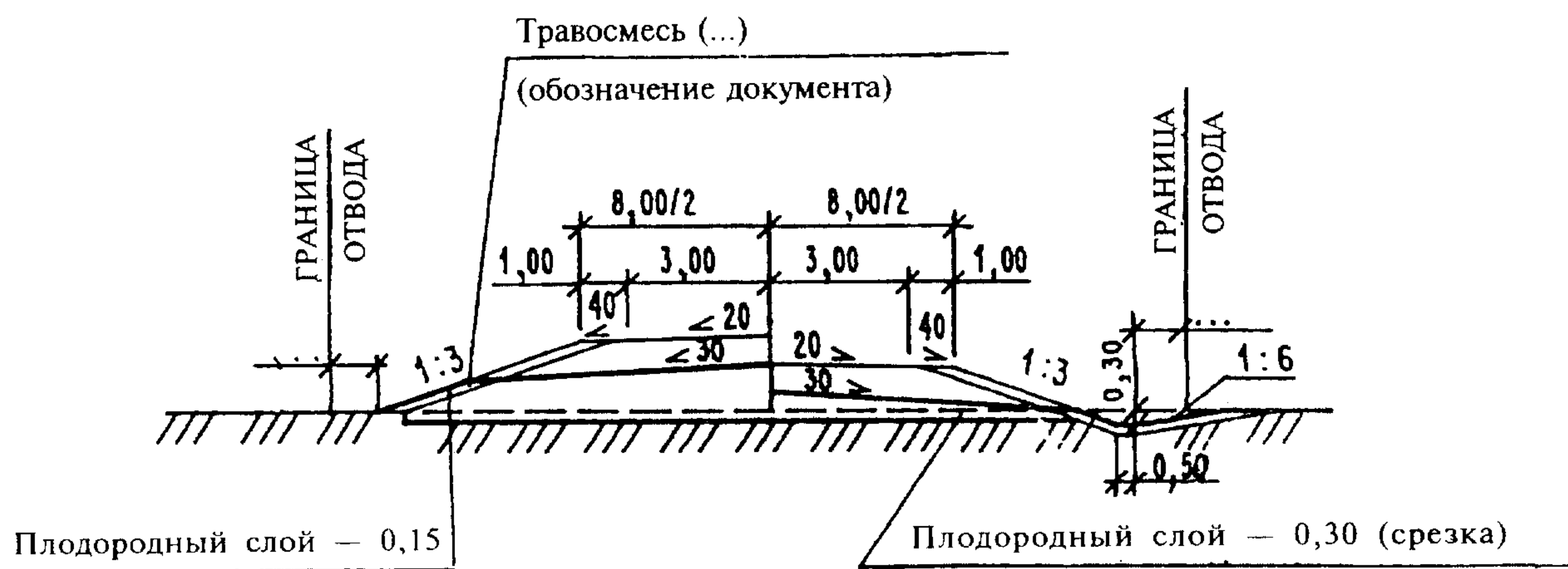
Тип 2 (насыпь до 2 м)
