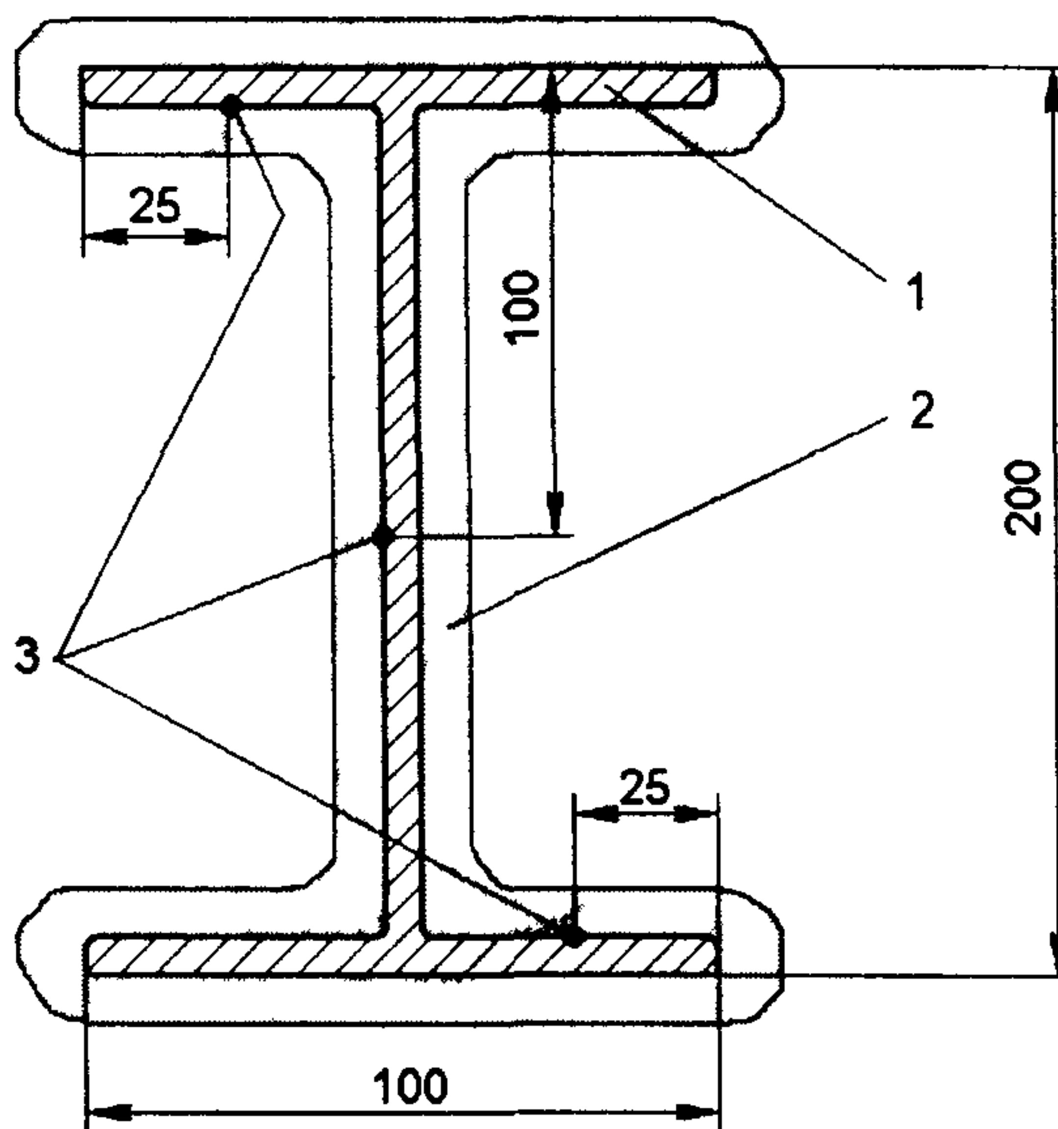
*Рис. 2. Схема расположения термоэлектрических преобразователей в среднем сечении на поверхности опытного образца:*
