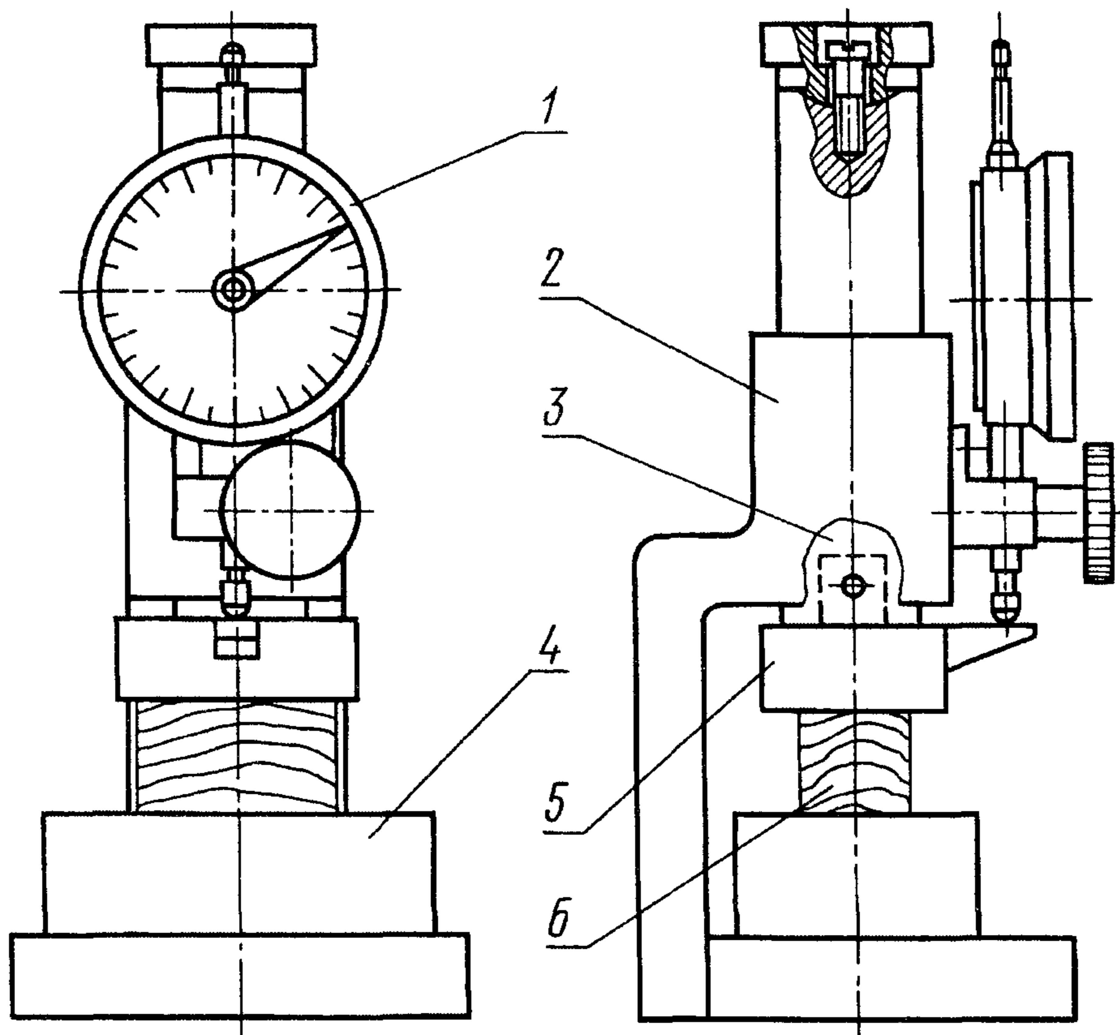
1 — индикатор; 2 — корпус; 3 — шток; 4 — подставка; 5 — съемный пуансон; 6 — образец.
