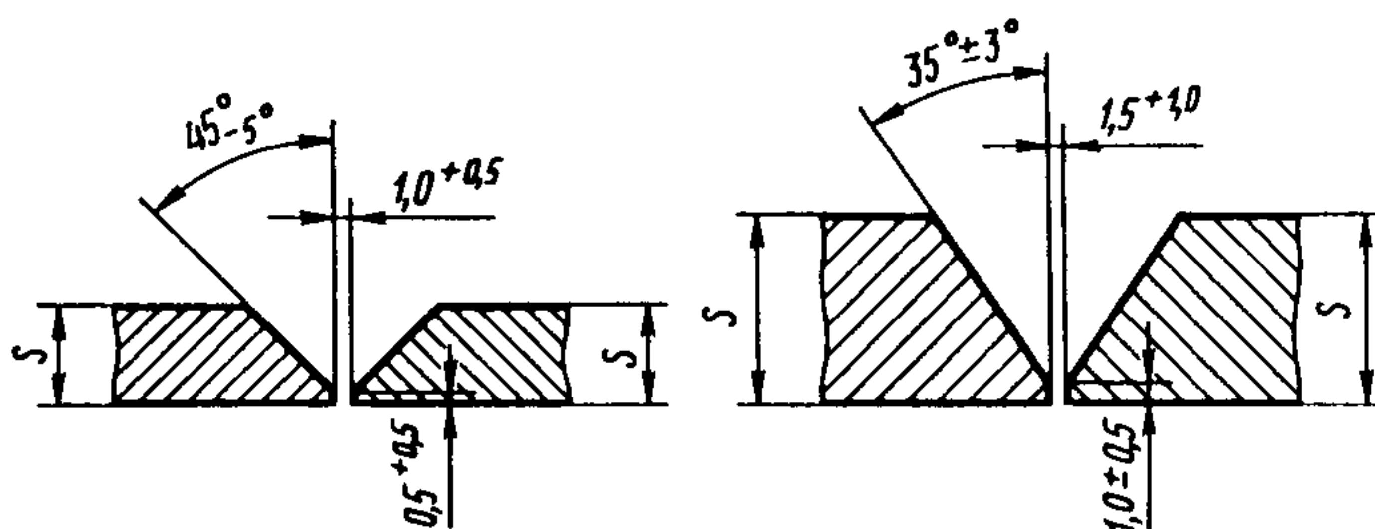
При *S* = 3,5—5,0 мм.При *S* = 8,0—10,0 мм.
