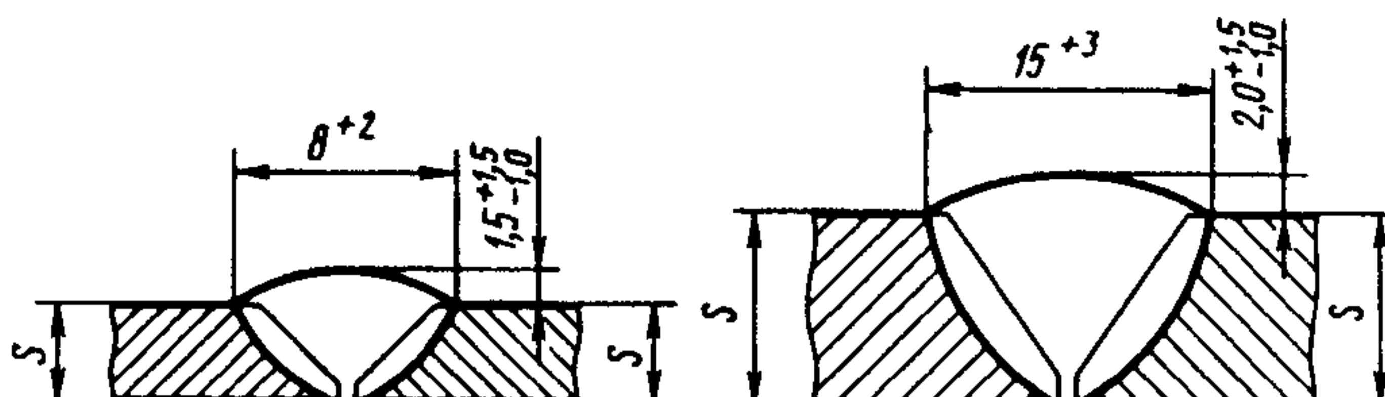
При *S* = 3,5—5,0 мм.При *S* = 8,0—10,0 мм.
