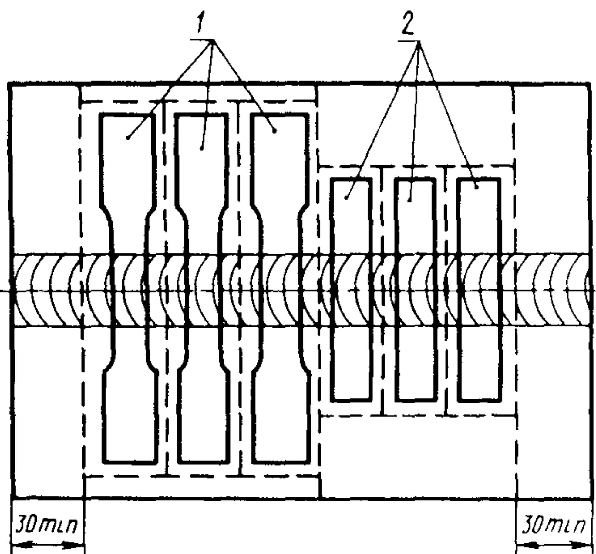
1 — образцы для испытания на статическое растяжение,
