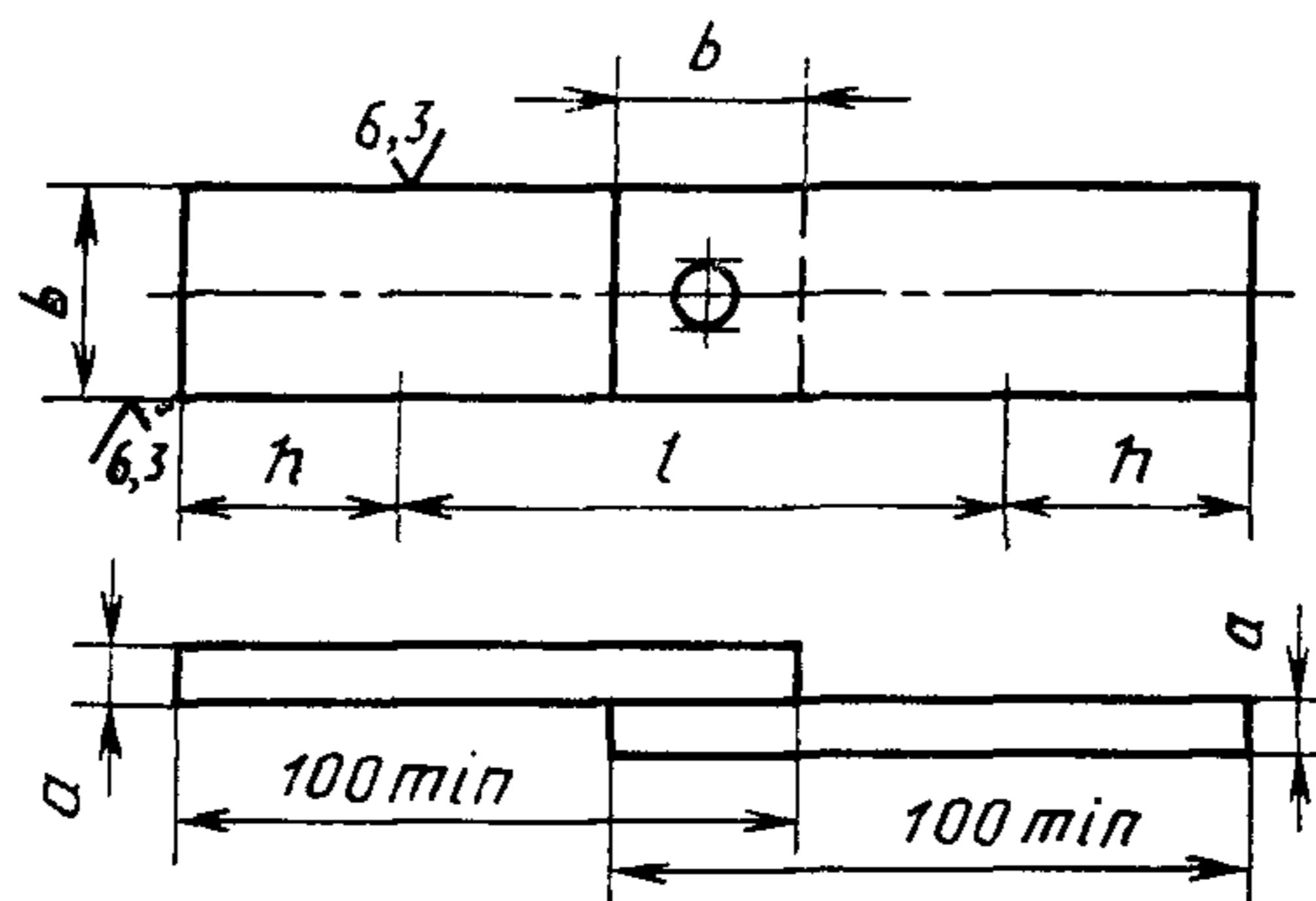
*a* — толщина основного металла, мм; *h* — длина захватной части (выбирается в зависимости от конструкции испытательной машины), мм; *l* — длина рабочей части образца, мм
