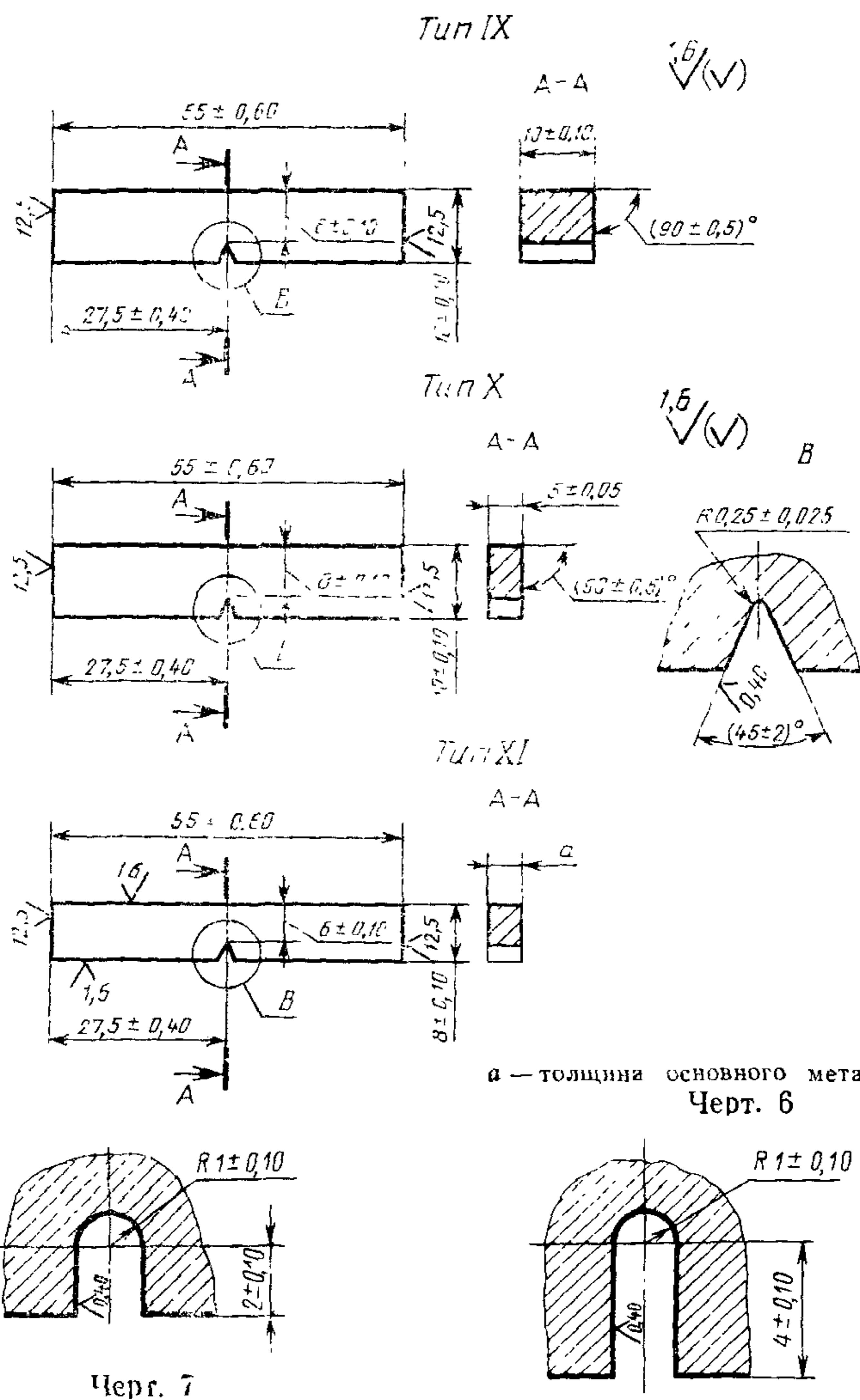
5.3. Условное обозначение ударной вязкости или работы удара включает: символ ударной вязкости (КС) или работы удара (К); вид надреза (концентратора) (U, V); температуру испытания (температура  $+20^\circ\text{C}$  не проставляется); максимальную энергию удара маятника (максимальная энергия в 300 Дж не проставляется); тип образца (тип образца VI и IX не проставляется);
