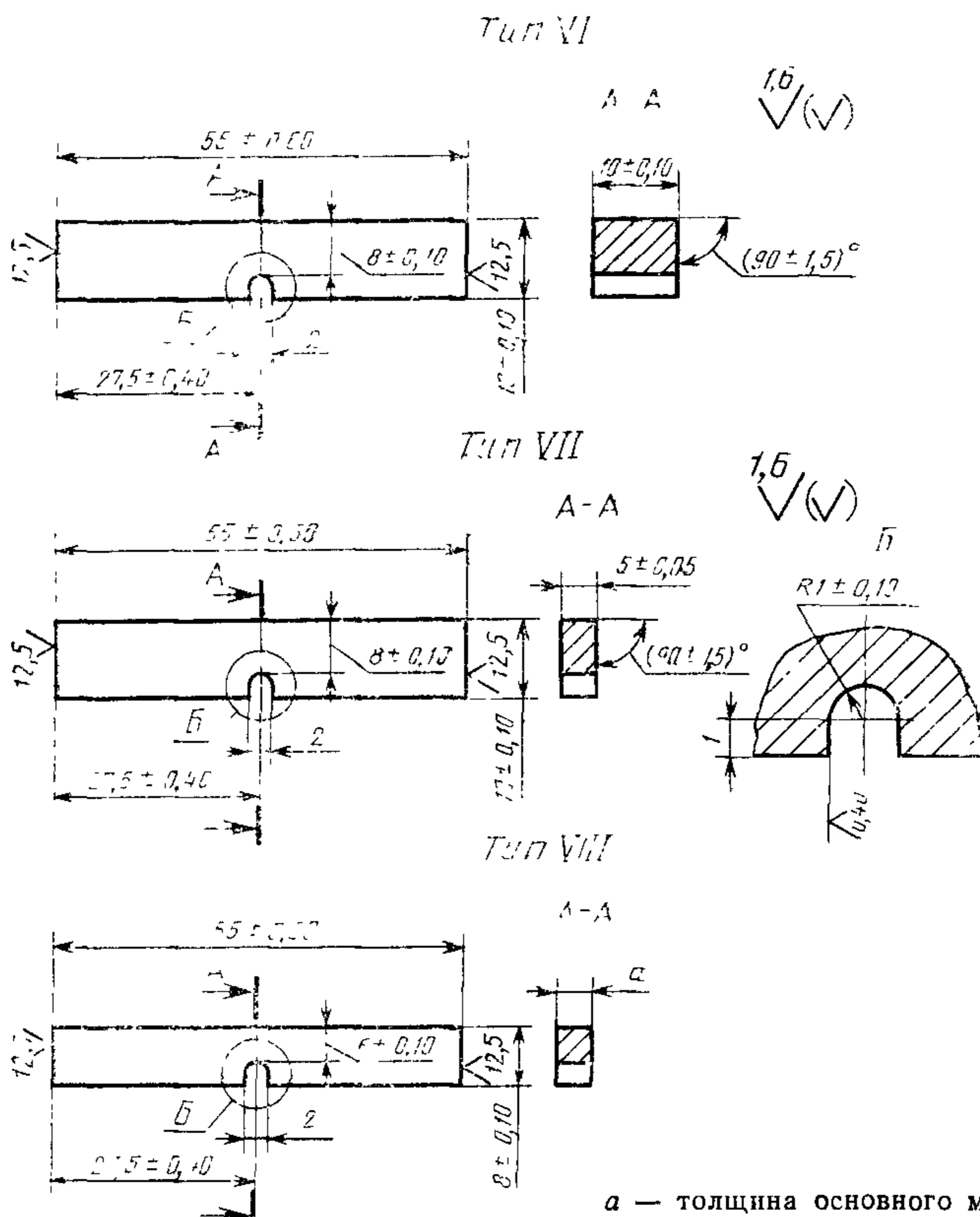
По требованию, указанному в нормативно-технической документации, разрешается применять образцы типа VI (см. черт. 5) с надрезом по черт. 7 или 8.
