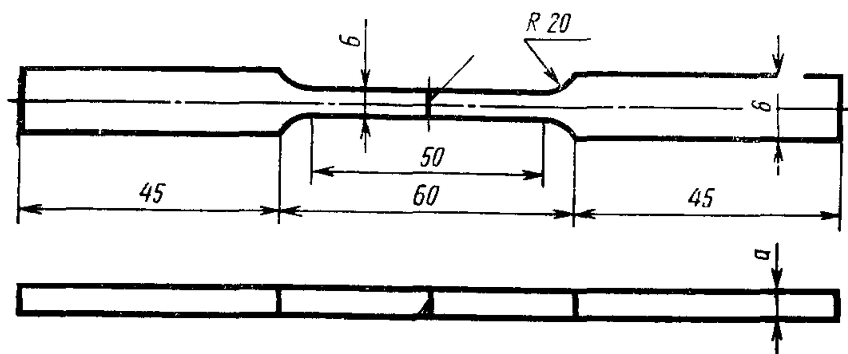
*a* — толщина основного металла в мм
