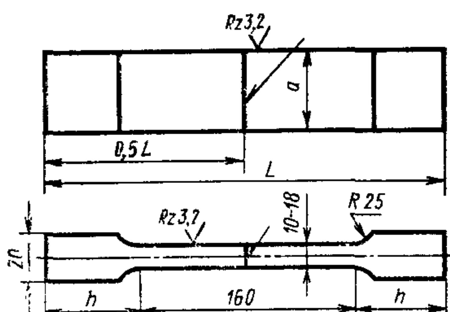
$a$  — толщина основного металла в мм
