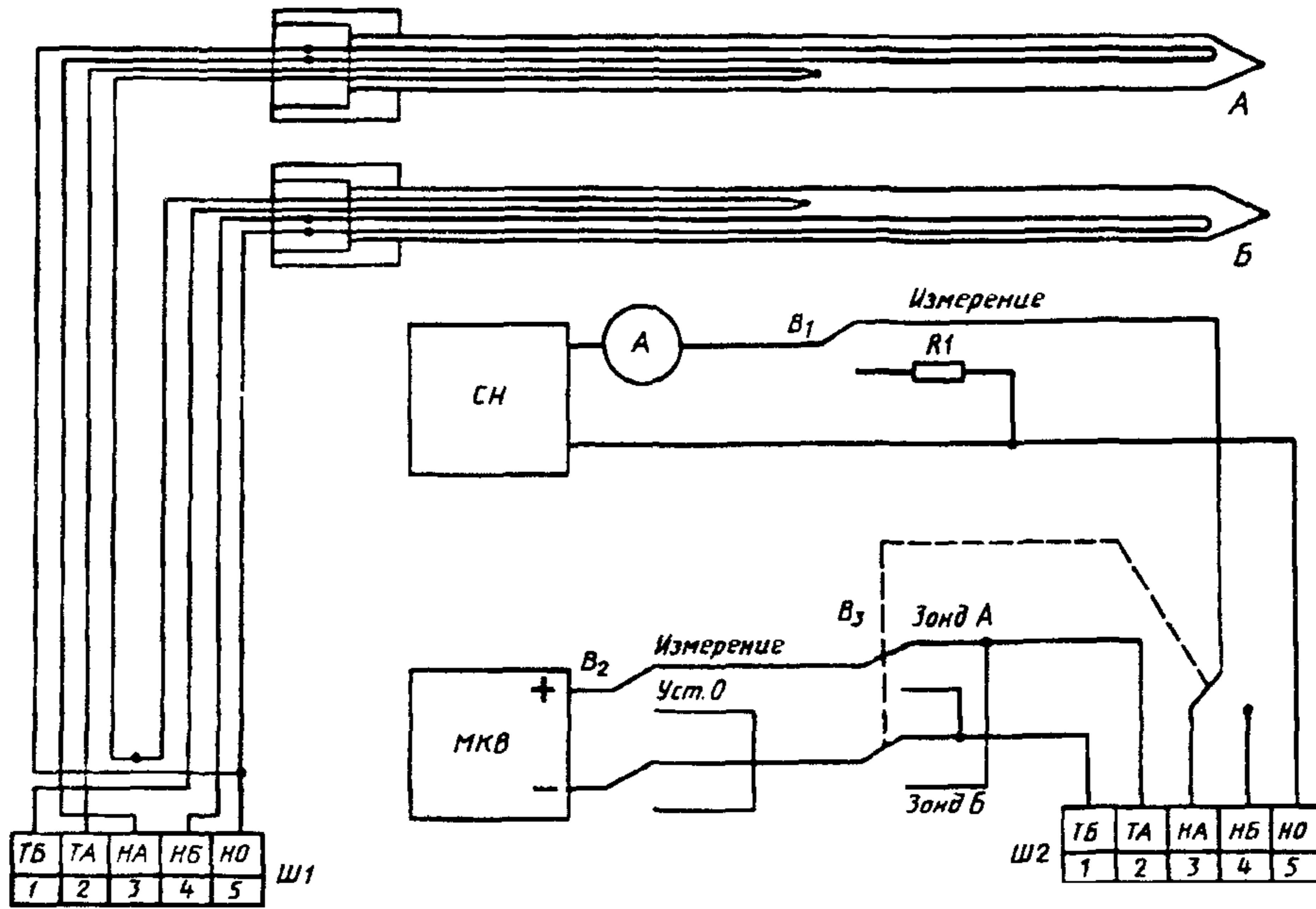
Рисунок 1 — Устройство зонда и электрическая схема соединения приборов
